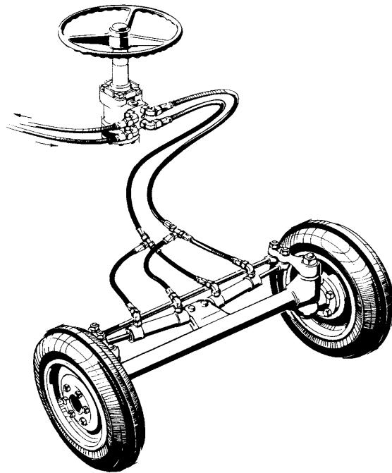
全液压转向器广泛用于工程车辆转向和船舶操舵。驾驶员通过它可以用较小的操纵力，实现较大的转向力控制，并且在性能上安全、可靠，操纵上轻便、灵活。
