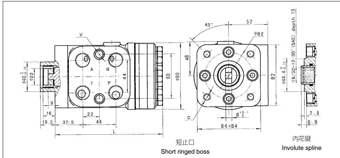
注1：图示短止口联接形式，长止口联接形式分别将图示 9、16 和 19.5 变为 18、25 和 30.5；
